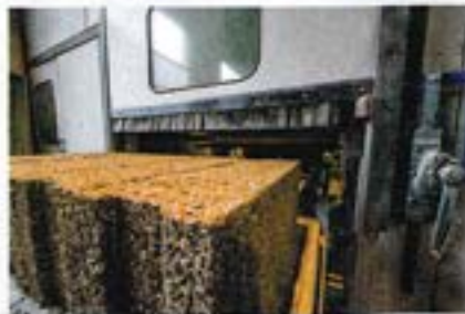
Bei der Herstellung von Hanfsteinen werden Hanfschäben mit besonderen Naturkalen und Mineralien in Form gepresst und luftgetrocknet.
